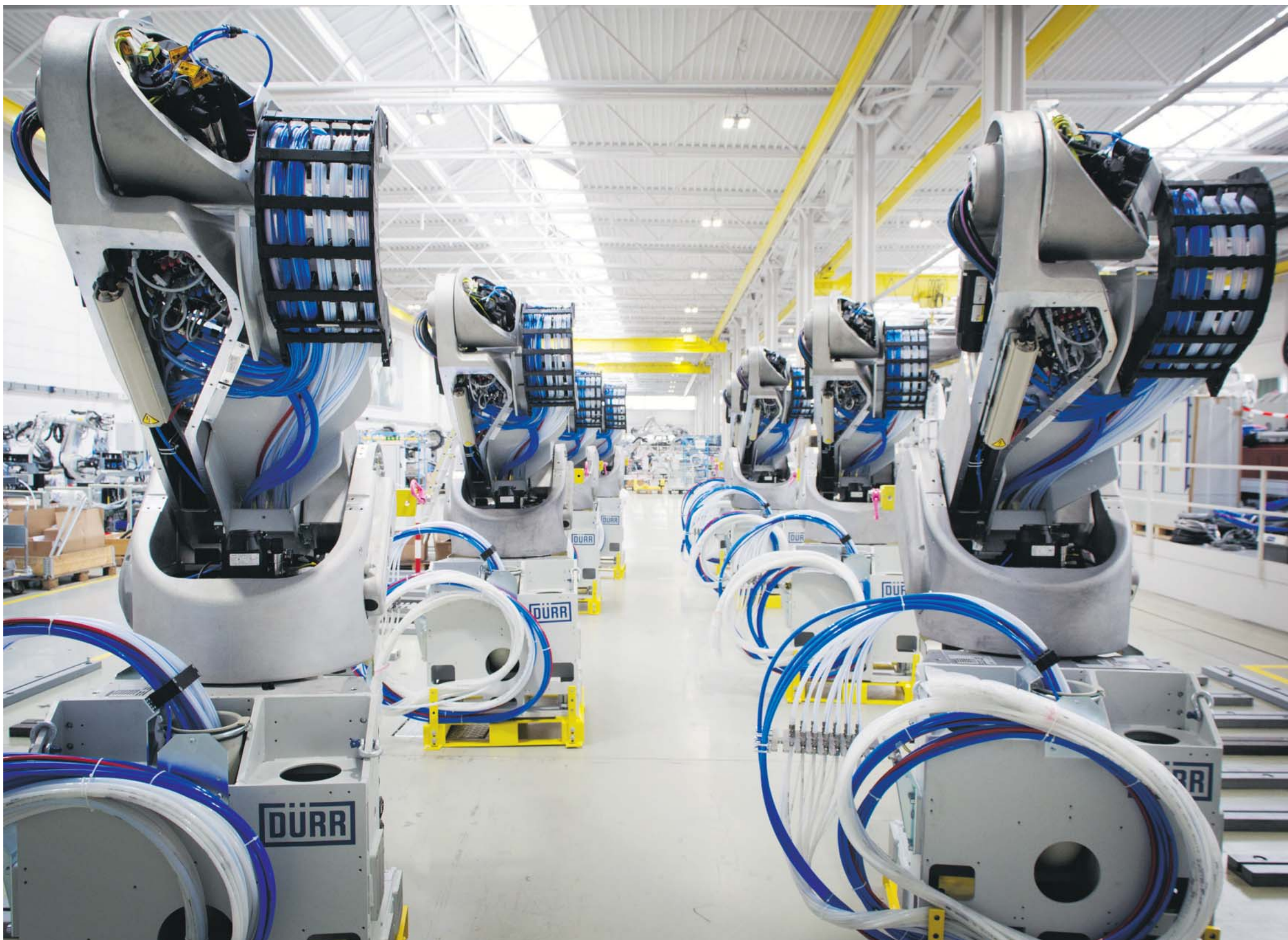
Das sind keine Kriegsmaschinen aus dem neuen „Star Wars“-Film, sondern Lackierroboter der Firma Dürr.
